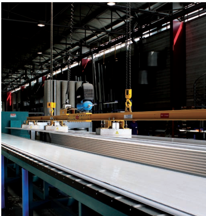
Approvisionnement des panneaux par convoyeur
