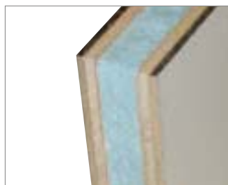
Panneaux de 32 mm composés de 2 tôles aluminium, 2 contreplaqués de 4 mm et d'une mousse.
